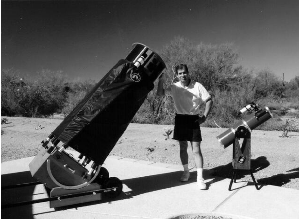
Gene Hanson con il suo riflettore Obsession da 45 cm F/4.5 e il telescopio da 15 cm f/5.
